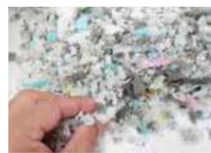
クッション中材には工場製造時に出る端材やリボンテッドフォームを再利用しました
