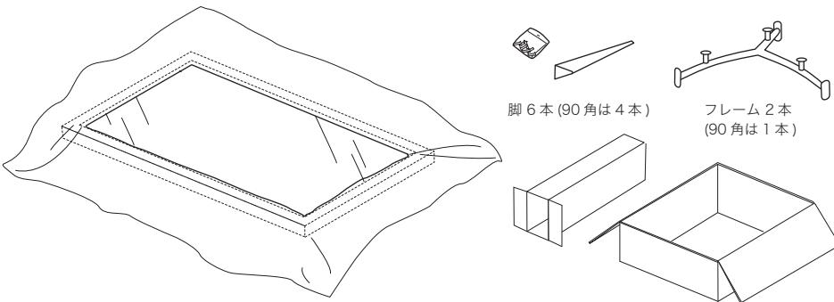
脚が入った箱がフレームが入っている箱に同封されています。ボルトとレンチが入った袋は脚の箱に貼り付けてあります。
