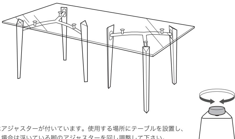
脚にはアジャスターが付いています。使用する場所にテーブルを設置し、ガタつく場合は浮いている脚のアジャスターを回し調整して下さい。
