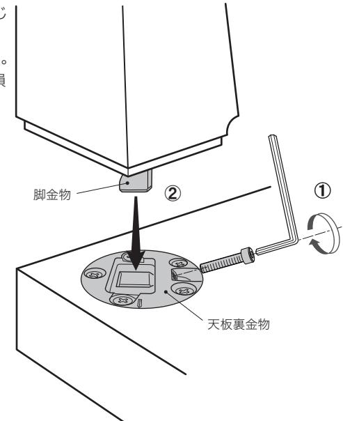
③脚と天板の角がズレないように、手で合わせながら、仮止めしたボルトを締めてください。
