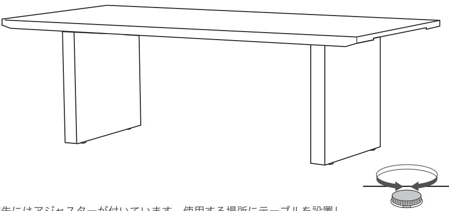
脚先にはアジャスターが付いています。使用する場所にテーブルを設置し、ガタつく場合は浮いている脚のアジャスターを回し調整して下さい。
