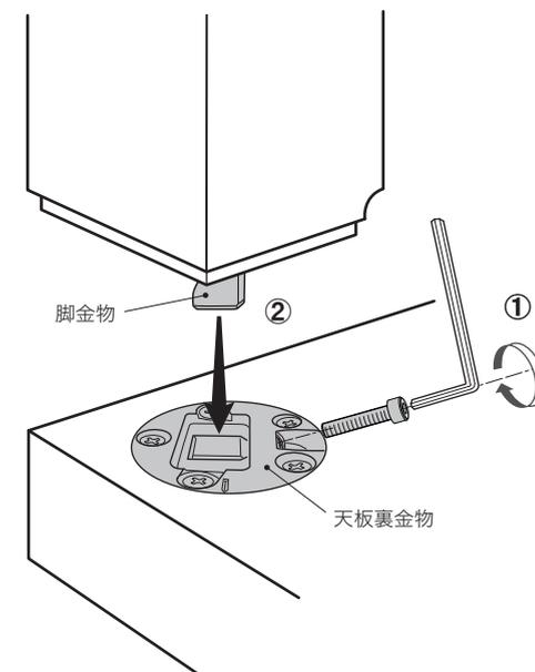
③脚と天板の角がズレないように、手で合わせながら、仮止めしたボルトを締めてください。
