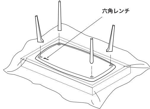
天板の裏面を上にして脚を組み付けます。
