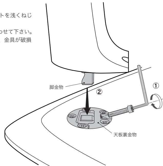
③脚と天板の角がズれないように、手で合わせながら、仮止めしたボルトを締めてください。
