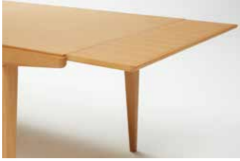
伸張式の天板は、テーブルのフォルムを損なうことなく天板小口に納められており、引出しながら上昇する特異な動作によって伸張時には天板トップと平滑になりホールドされます。収納時も天板を伸張した際にも、伸張式テーブルとは思えないフォルムを実現しました。(特許出願中)
